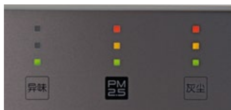
A Triple Clean monitoron látható a szagok, a PM2,5 részecskék és a por állapota.
